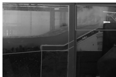
图 7 模型试验中波浪冲击胸墙发生破碎、越浪瞬间实景图
