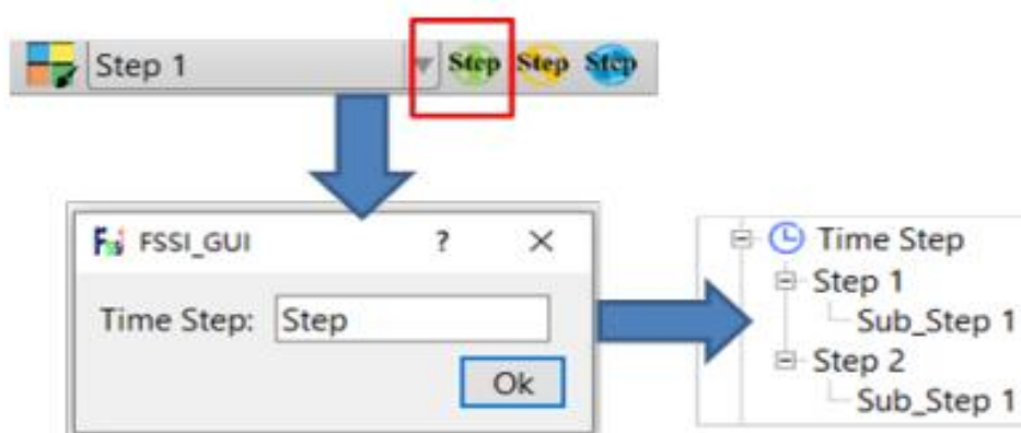
图 2.14 增加时间步的步骤示意图
