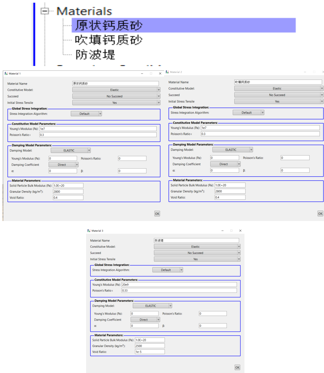
图 2.8 Step1 材料参数设置
