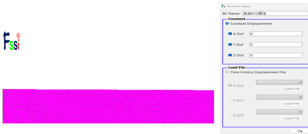
(c) 底部表面 XYZ 方向位移固定
